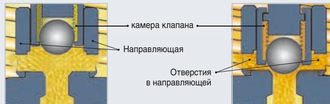
Держатель клапана перекрывает отверстия в направляющей, а клапан приближается к седлу. Количество отводимого конденсата резко падает.
