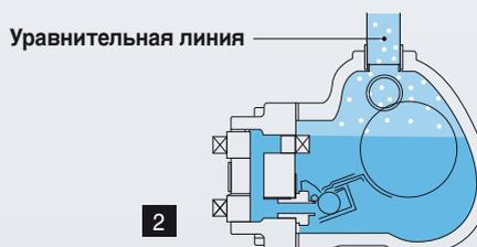
При запуске конденсат поступает в конденсатоотводчик. Поплавок всплывает и происходит отвод конденсата.
