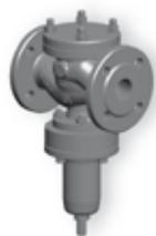
REA20 является редукционным клапаном прямого действия и предназначен для сжимаемых сред, таких как воздух и другие газы, а также для несжимаемых сред, таких как вода, нефть и другие. Клапан поддерживает постоянный уровень выходного давления при стабильном давлении на входе и при стабильном расходе пара. Клапаны этого типа могут применяться в широком диапазоне давлений.
