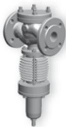
RE20 является редукционным клапаном прямого действия и предназначен для пара. Клапан поддерживает постоянный уровень выходного давления при стабильном давлении на входе и при стабильном расходе пара на выходе. Клапаны этого типа могут применяться в широком диапазоне давлений.
