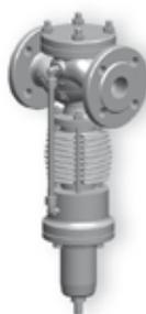
RE20L является редукционным клапаном с импульсной линией и предназначен для пара. Редукционный клапан поддерживает постоянный уровень выходного давления даже при изменении давления на входе. Клапаны этого типа могут применяться в широком диапазоне давлений. Редукционный клапан может использоваться при периодически отключающихся нагрузках на выходе. Он обеспечивает надёжное закрытие при давлении на выходе равным нулю.
